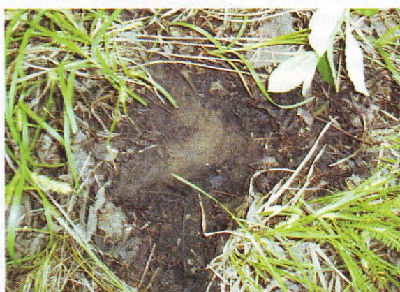
Рисунок 1 – Пятно утечек ПХБ на БСК под поврежденным конденсатором
