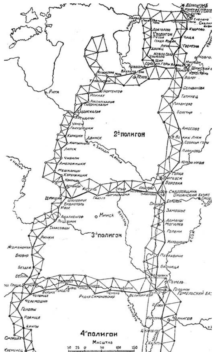
Рисунок 4 – Схема триангуляции 1 класса по программе И.И. Померанцева
