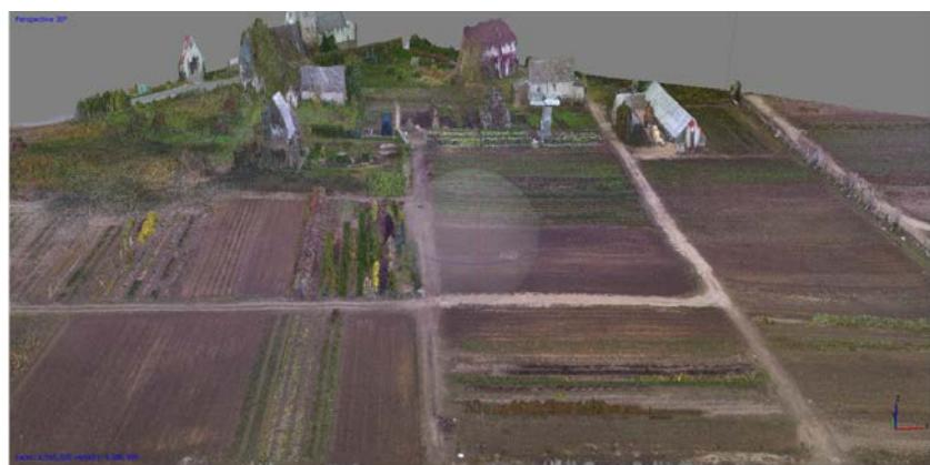
Рисунок 2 — Текстурированная цифровая модель местности
