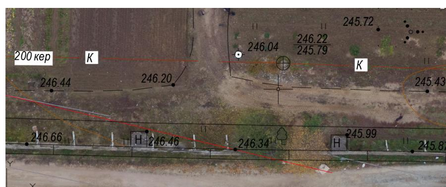
Рисунок 4 — Сравнение ортофотоплана с ЦММ, полученной по результатам наземной электронно-таксеометрической съемки
