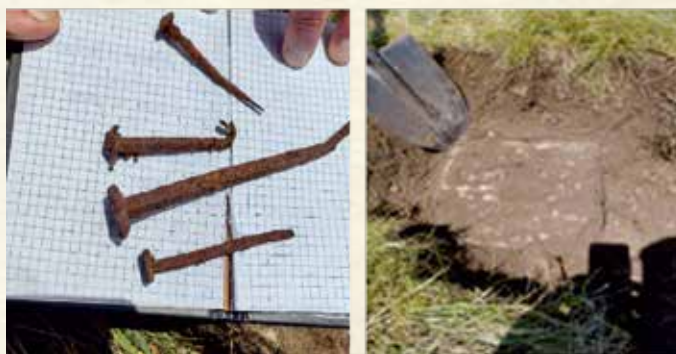
Обнаружены признаки наружного геодезического знака и центр пункта
