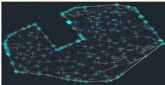
Рисунок 1 – Результат добавления точек к поверхности TIN
