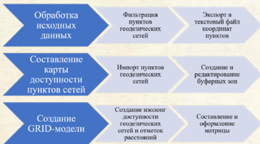
Рисунок 2 – Методика составления карты доступности геодезических сетей
