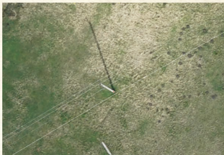
Рисунок 3 – Определение центров оснований столбов линий электропередач в ПО Trimble Inpho (выполнялось в стереорежиме)
