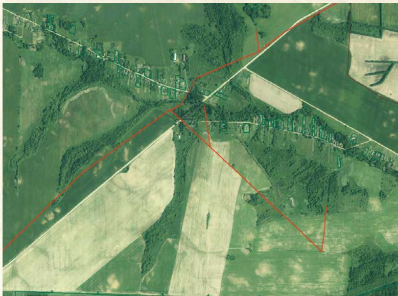
Рисунок 2 – Вид оцифрованной линии электропередач по материалам аэрофотосъемки, созданной на основе обзорных схем
