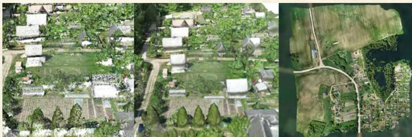
Рисунок 1 – Облако точек ( а ), полигональная модель ( б ) и ортофотоплан местности ( в ), полученные в результате обработки совместной съемки
