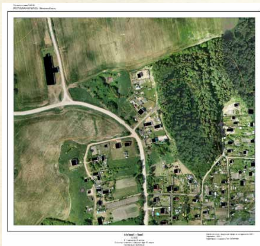
Рисунок 2 – Фотодокумент на территорию вблизи г. Минска, разработанный на основе АФС и ВЛС с борта БЛА мультироторного типа, с использованием ГИС «Панорама»
